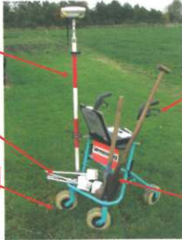
Vermessungstauglicher Rollator für den Geländeeinsatz im Außendienst
