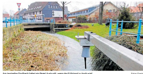
Am Jeasterder Dorfbach liefert ein Pegel Auskunft, wenn der Füllstand zu hoch wird.
